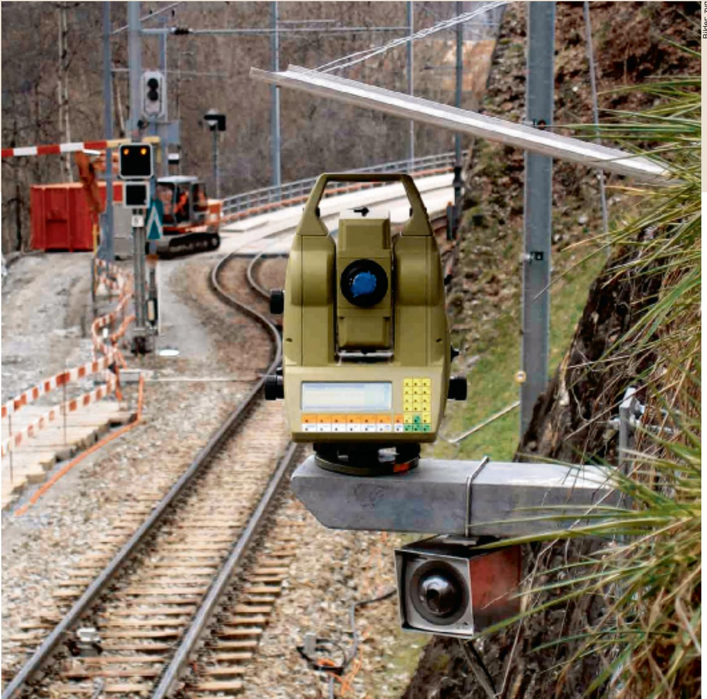
Automatisierte Überwachung bei der Instandsetzung des Fatschazertobel-Viadukts.
